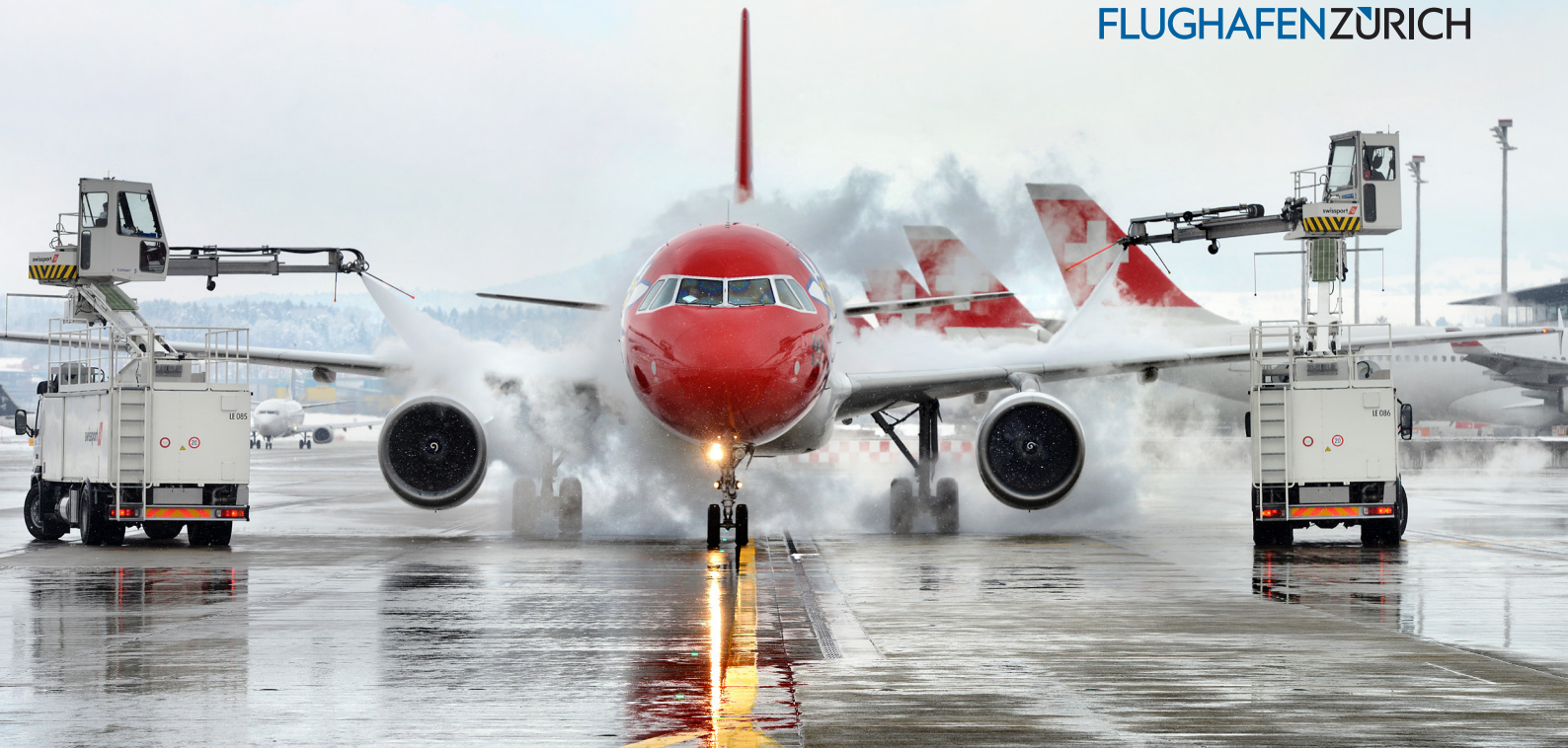
Enteisung am Flughafen Zürich
